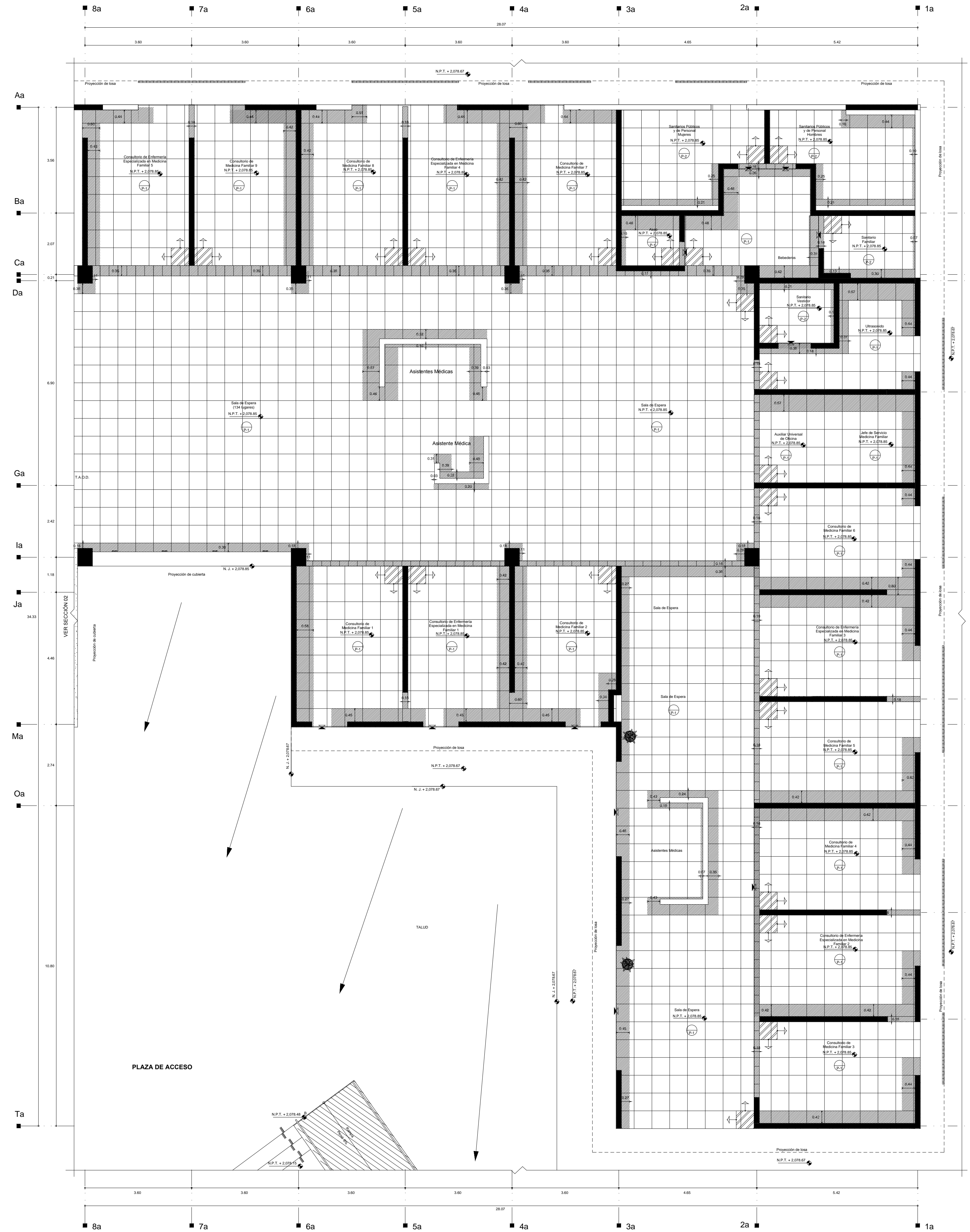
DESPIECE DE PISOS PLANTA BAJA, SECCIÓN 01
